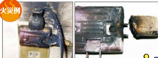
コンセントに差したプラグの差し刃間についた埃が湿気を帯び、そこで小さなスパークを繰り返し、時間の経過とともに電気回路が形成され出火する現象をトラッキング現象といいます。
