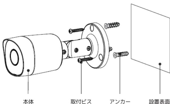
注意）設置面が必ずカメラ本体の3倍以上の重量に耐えられる強度であることを確認して下さい。
