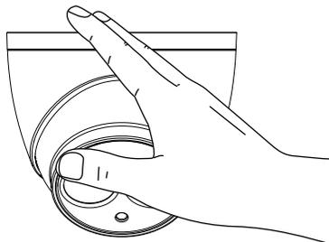
電源を入れてカメラ前面（照度センサー）を手で覆い隠すと、レンズ付近のLEDが赤色で点灯することを確認できます。
