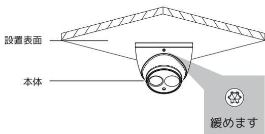
注意）設置面が必ずカメラ本体の3倍以上の重量に耐えられる強度であることを確認して下さい。
