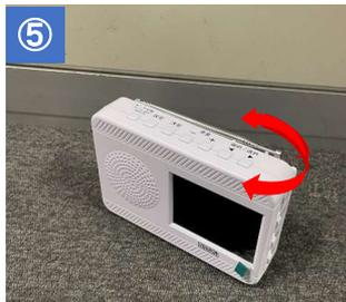
「AM」では本体内部にアンテナがあるため、電波の入りやすい場所で本体の向きを動かして調整します。
