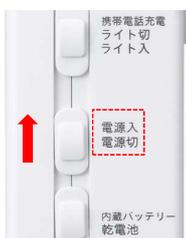
電源切替スイッチを合わせた後、「電源スイッチ」を「電源入」側にスライドさせ電源を入れます。
