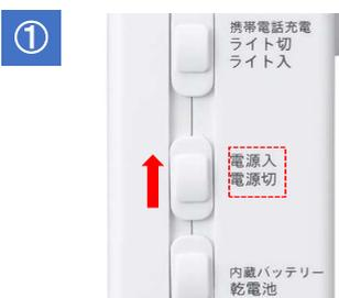
電源切替スイッチを合わせた後、「電源スイッチ」を「電源入」側にスライドさせ電源を入れます。
