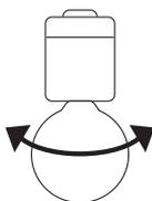
〔3〕 図3のように、ランプを回しソケットに取り付けて下さい。また、ランプの交換時には逆に回し、取り外して下さい。
