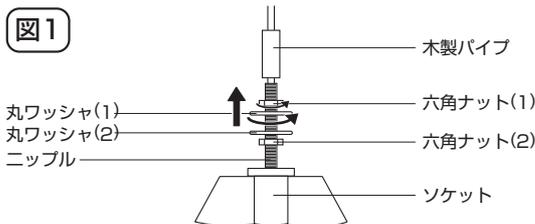
〔2〕 図2のように、金具にコードを先に通し、お好みのソケット位置を決め、六角ナット(2)と丸ワッシャー(2)を固定し、図のように丸ワッシャー(1)と金具を丸ワッシャー(2)で挟むように六角ナット(1)を回し、固く締め付けて下さい。また木製パイプをニップルの上に被せて下さい。
