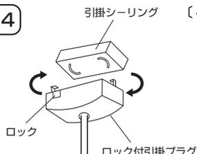
〔4〕 図4のように、ロック付引掛プラグを「カチッ」と音がするまで回し、引掛シーリングに取り付けて下さい。取り外す場合はロックボタンを押しながら「カチッ」と音がするまで逆に回し取り外して下さい。
