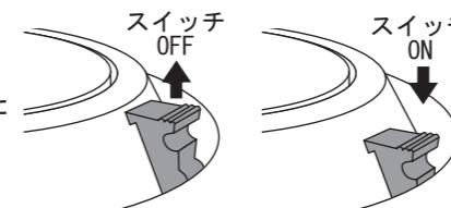
周波数切換スイッチを切換える場合は、必ずドライバー等で切換えてください。爪などで切換えると、爪などの破損や怪我のおそれがあります。
