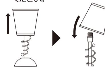
**[3]** 取付金具を図の向きでソケットに合わせ、右に回してソケットとセードをしっかりと固定します。
