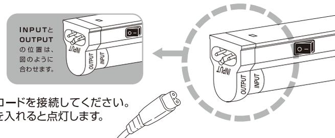
2. INPUTマークがある方のコネクターに電源コードを接続してください。電源プラグをコンセントに差し込み、スイッチを入れると点灯します。
