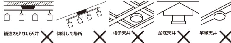
次のような配線器具には取り付けないでください。(火災、感電、落下によるけがの原因になります。)
