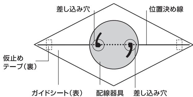
**2** ガイドシートの位置決め線にランプ本体の矢印を合わせ、本体裏面の引っ掛けシーリング用金具を配線器具に差し込みカチッときがして止まるまで時計回りに回し、取り付けてください。
