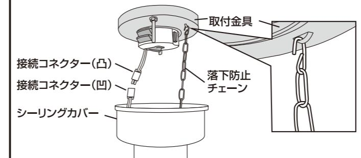
**4** ワンタッチアダプターから出る接続コネクター(凸)を、器具から出ている接続コネクター(凹)に接続してください。
