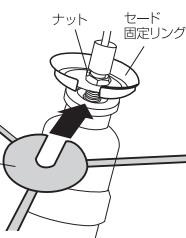
ナットを時計周りに回しホルダーパートが動かないように固定します。
