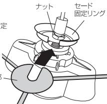
ナットを時計周りに回しホルダーパートが動かないよう固定します。
