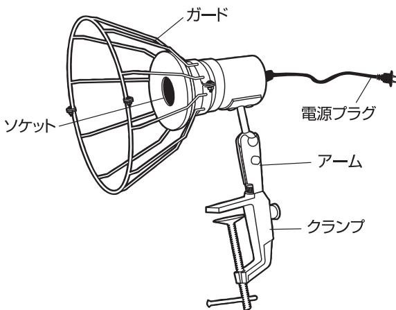
\*ガード用取付ネジのナットは、抜け止め防止のためナイロンナットを使用しています。
