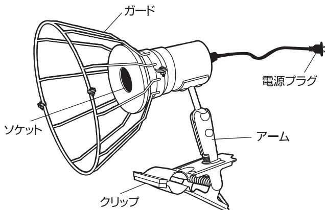
※ガード用取付ネジのナットは、抜け止め防止のためナイロンナットを使用しています。
