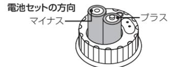
※ 乾電池の取り外し時、セット時には、必ずカバーなどに水気がないことを確認し、作業を行ってください。電池やカバーが濡れていた場合や、電池カバー内部(電池ボックス内)に水が入ると、製品の故障の原因となります。
