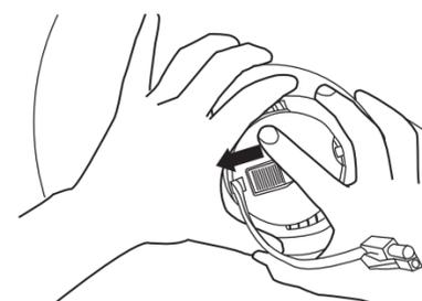
本体が落ちないように支え、ワンタッチアダプターのレバーをロック解除の方に押し本体を外します。
