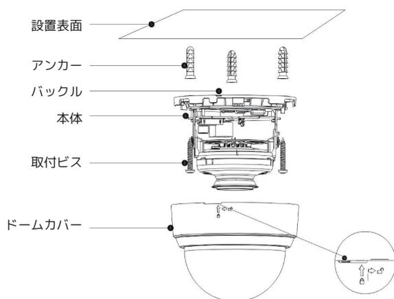
注意) 設置面が必ずカメラ本体の3倍以上の重量に耐えられる強度であることを確認して下さい。
