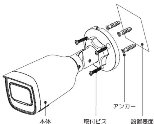
注意）設置面が必ずカメラ本体の3倍以上の重量に耐えられる強度であることを確認して下さい。
