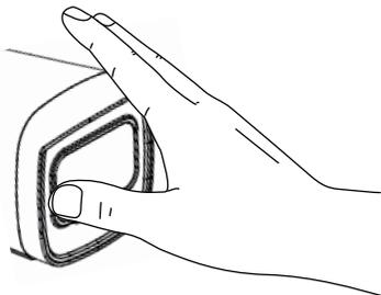
電源を入れてカメラ前面（照度センサー）を手で覆い隠すと、レンズ付近のLEDが赤色で点灯することを確認できます。
