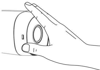
電源を入れてカメラ前面（照度センサー）を手で覆い隠すと、レンズ付近のLEDが赤色で点灯することを確認できます。
