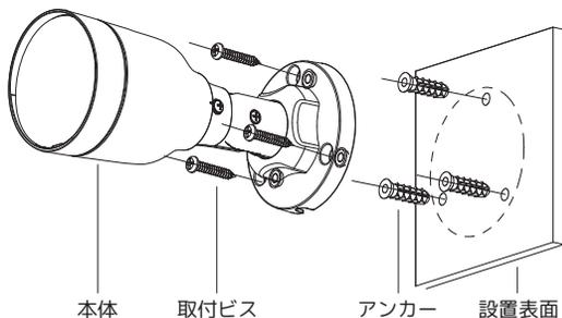
注意) 設置面が必ずカメラ本体の3倍以上の重量に耐えられる強度であることを確認して下さい。
