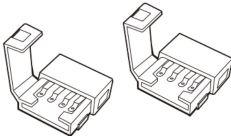
本製品は、LEDテーブライトの延長に使える連結コネクタです。LEDテーブライトの端子をコネクタに挟むだけの簡単取り付け。
