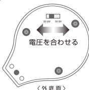
使用する国や各地域の電圧に合わせて、電圧切替スイッチを切り替える。
