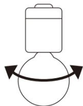
〔3〕 図3のように、ランプを回しソケットに取り付けて下さい。また、ランプの交換時には逆に回し、取り外して下さい。
