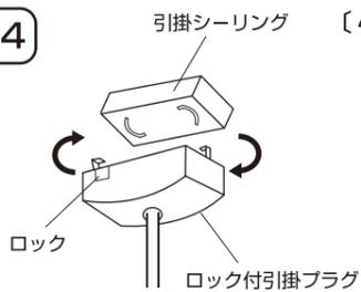
〔4〕 図4のように、ロック付引掛プラグを『カチッ』と音がするまで回し、引掛シーリングに取り付けて下さい。取り外す場合はロックボタンを押しながら『カチッ』と音がするまで逆に回し取り外して下さい。
