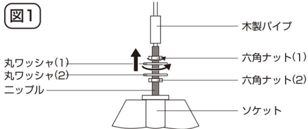
〔2〕 図2のように、金具にコードを先に通し、お好みのソケット位置を決め、六角ナット(2)と丸ワッシャ(2)を固定し、図のように丸ワッシャ(1)と金具を丸ワッシャ(2)で挟むように六角ナット(1)を回し、固く締め付けて下さい。また木製パイプをニップルの上に被せて下さい。
