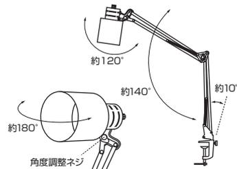
※可動部は可動範囲以上に動かさないでください。転倒およびアーム部の破損の原因になります。
